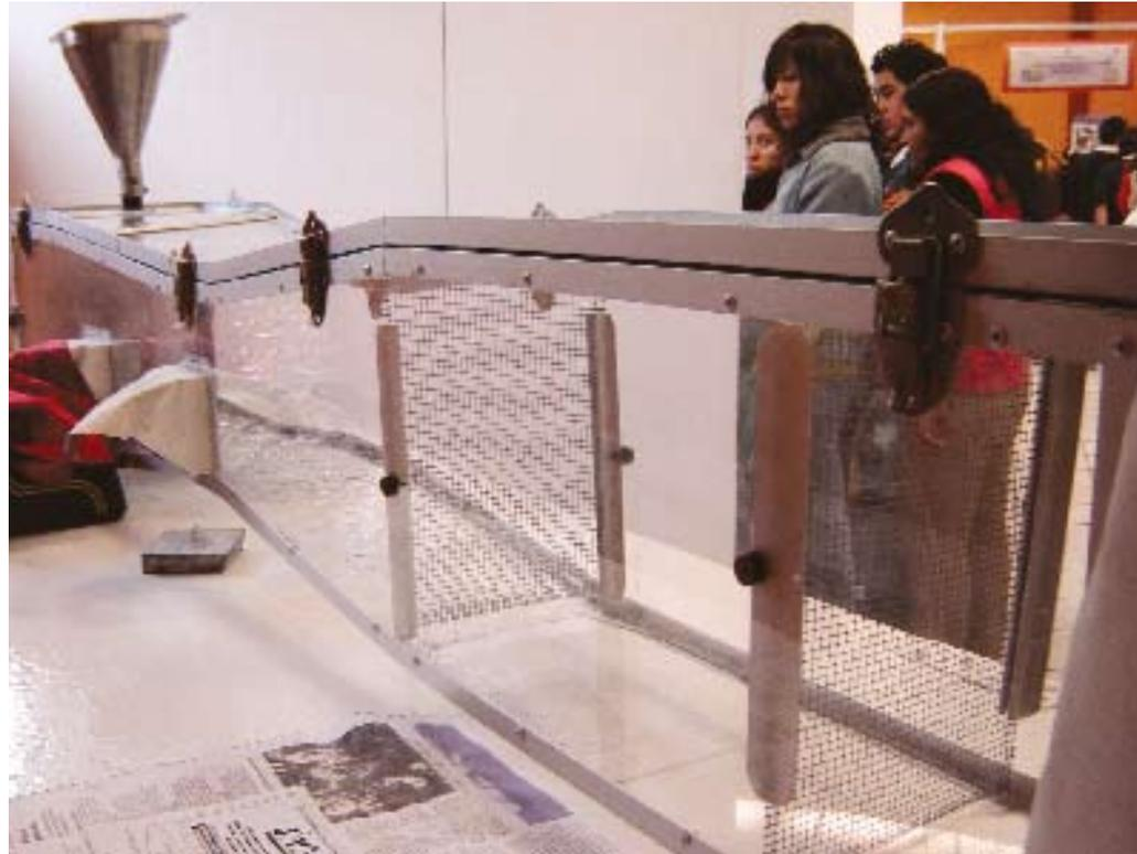
sólo 250 mililitros de la mezcla líquida de agua y jabón por hora; el dispositivo debe colocarse en la parte media de la chimenea, ya que allí se concentra la mayor cantidad de partículas contaminantes. Asimismo, en la parte superior del conducto se instala una malla a fin de evitar que las pompas no reventadas puedan salir.
