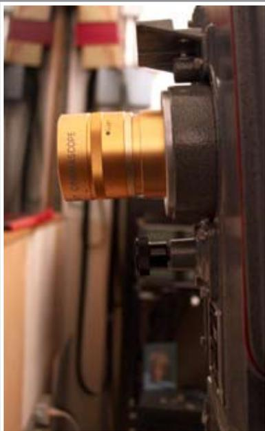
Para su exhibición se utiliza un proyector que está constituido por una cabeza de proyección simplex, cabeza de sonido simplex, rectificador, monitor procesado y amplificadores, ensamblado en Estados Unidos.
